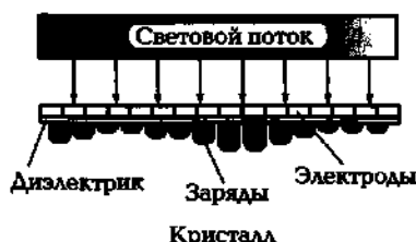
Рис. 6.4. Устройство и принцип действия ПЗС-линейки
