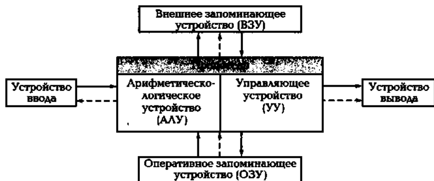
Рис. 2.1. Архитектура ЭВМ, реализующая принципы фон Неймана:
