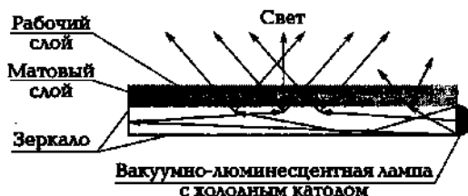
Рис. 4.6. Подсветка в мониторе по DSTN ( Double Super Twisted Nematic )-технологии
