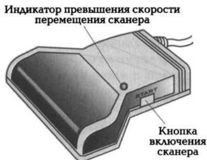
Рис. 6.9. Устройство ручного сканера
