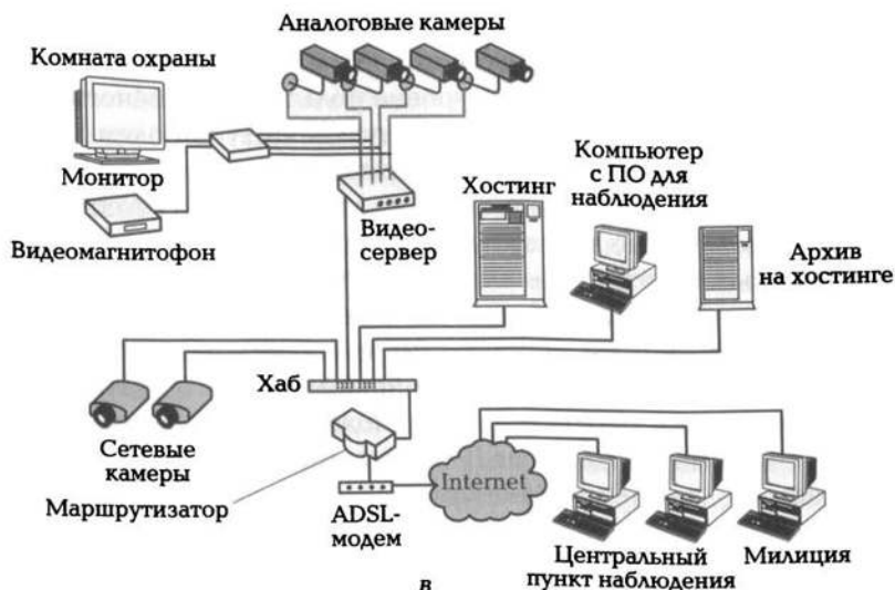
Рис. 6.15. Варианты подключения Web-камеры:
