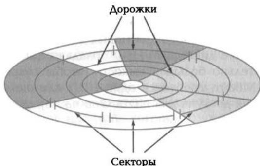
Рис. 3.3. Разбиение магнитного диска на дорожки и секторы при форматировании
