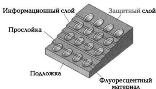
Рис. 3.13. FM-диск в разрезе
